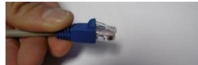
**Muffe über Verriegelungsvorrichtung zurückschieben**
