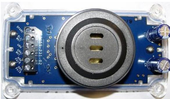
**HINWEIS: ALLE ALARME EINES GEMEINSAMEN SENSORS SOLLTEN IN REIHE GESCHALTET UND SO MITEINANDER VERBUNDEN WERDEN. WENN BEISPIELSWEISE SENSOR 1 ZWEI ALARME TREIBEN MUSS, SOLLTE EIN KABEL ZWISCHEN SENSOR 1 UND ALARM 1 VERLAUFEN UND EIN KABEL ZWISCHEN ALARM 1 UND ALARM 2 (BEACHTEN SIE DAS BEISPIEL IN ABSCHNITT 7.4.2).**
