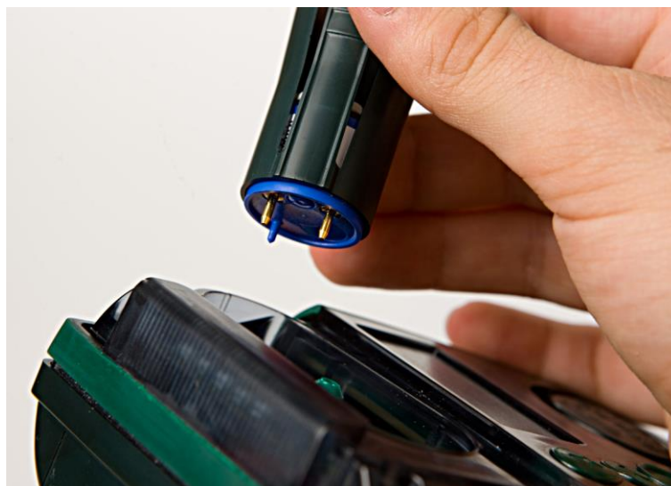
Figure 22 Retrait du capteur d'oxygène
