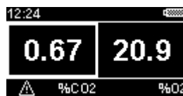
Figure 5 Écran principal des gaz avec les niveaux de dioxyde de carbone ayant déclenché une alarme
