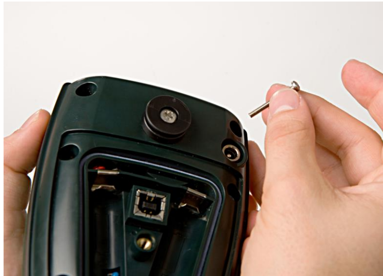
Figure 27 Remplacement du couvercle du capteur et fixation des vis
