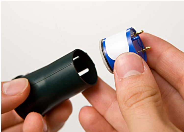
Figure 23 Insertion du nouveau capteur dans l'outil d'extraction
