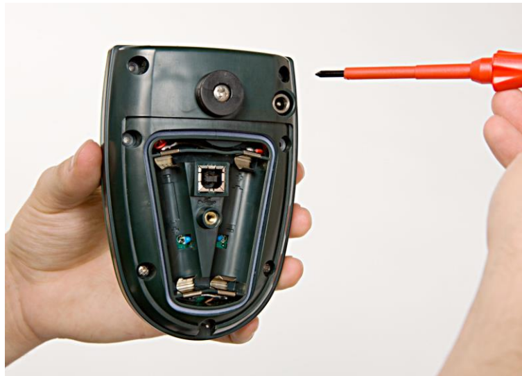
Figure 16 Retrait des vis du couvercle du capteur
