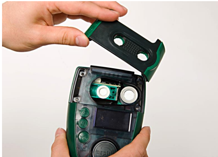
Figure 17 Retrait des vis du capteur
