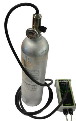
Paso [4] Coloque el regulador en la botella del gas de comprobación de bajo nivel de O 2 .
