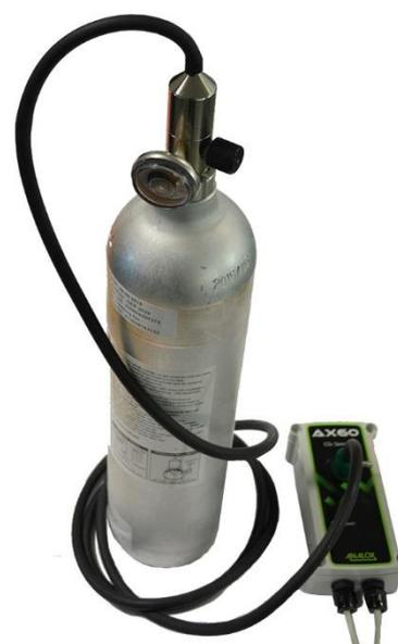
步骤 [4] 将调节器安装到氧气低检气瓶上
