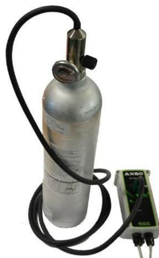
步骤 3] 将流量适配器插入二氧化碳感应器上的孔内      步骤 4] 将调节器安装到 CO2 检查气体瓶中
