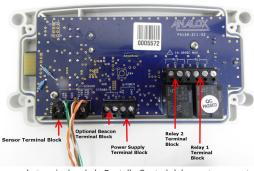
Los bloques de terminales de la Pantalla Central deben estar conectados a la fuente de alimentación, el sensor, la baliza y los relés (si es necesario).
