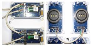
La conexión en serie es el medio por el cual las alarmas pueden conectarse secuencialmente. Siga la misma secuencia de cableado que se describe en el paso 5. Tenga en cuenta que el acceso al cableado está solo en la parte posterior de la unidad. El cableado se puede conectar a través del "orificio ciego" en la parte posterior de la unidad o los casquillos opcionales (para guitar los discos de eliminación) en la parte inferior de la unidad.
